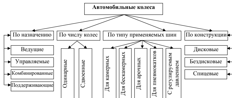
Рис. 8.1. Типы автомобильных колес
