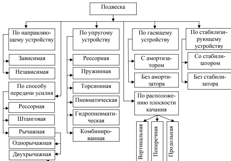
Рис. 7.2. Типы подвесок с классификацией по признакам
