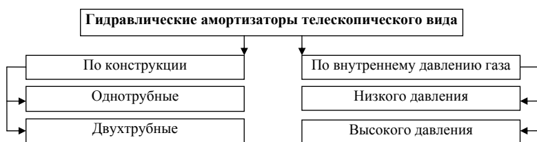
Рис. 7.13. Типы гидравлических телескопических амортизаторов
